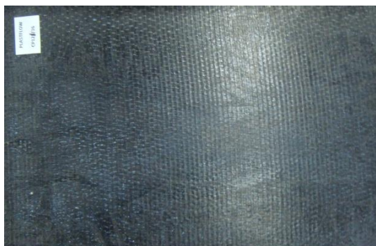
Figura 5. Placa de C/C-SiC fornecida para ensaios de ablação.
